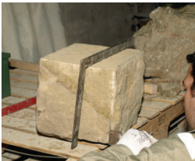
Squadratura di una pietra con scapezzatore e squadra durante il corso per scalpellini nel 2016 (foto Mauro Chinni).
