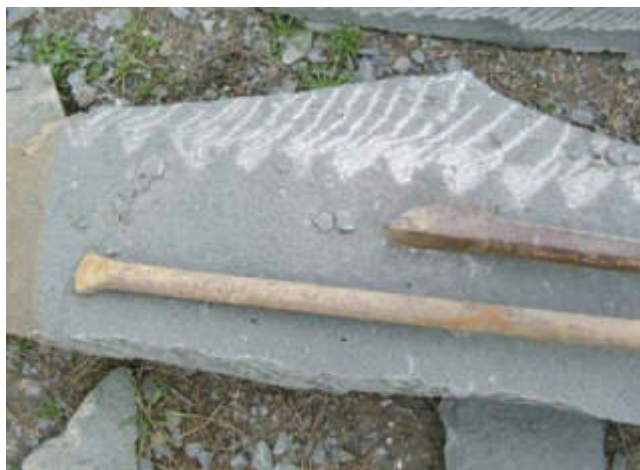
Barramina per forare e palanchino per spostare i blocchi.
