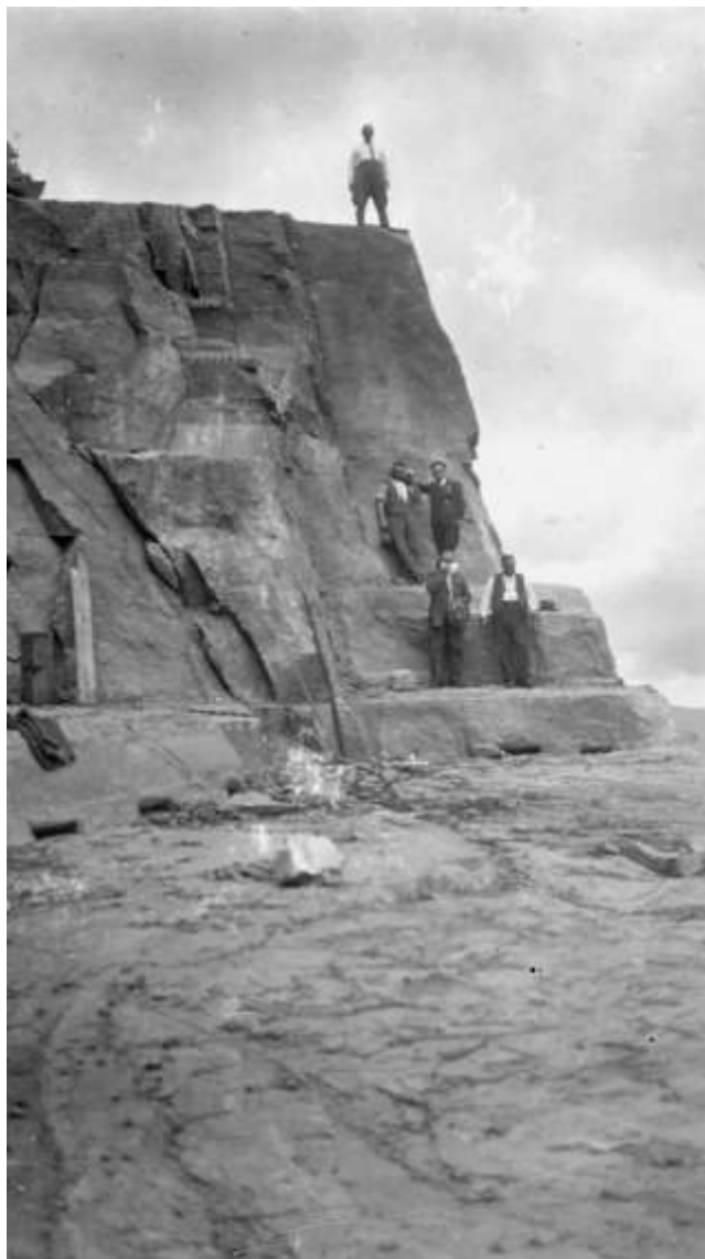
Nella parete rocciosa si possono notare le terrazze formate dallo stacco dei blocchi di pietra nella cava della Casona (pr. Giovanni Vecchi).
