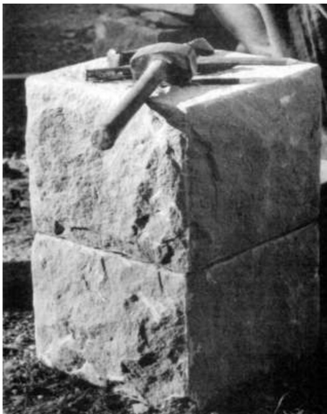
Conci di pietra per pilastro sbozzati o a bugna rustica (foto Aniceto Antilopi).
