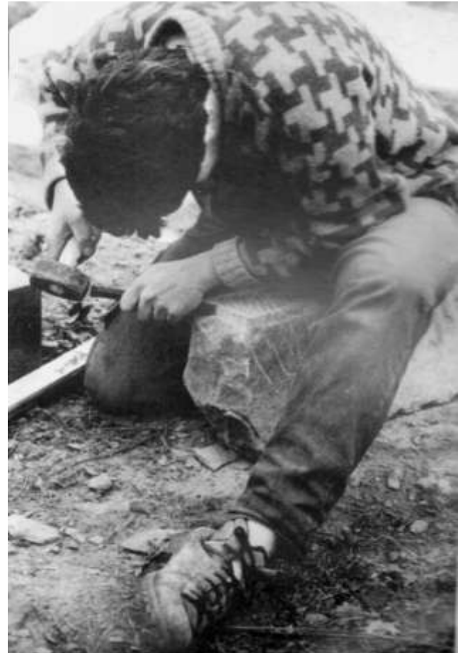
Esecuzione del bordo con scalpello (nastrino o filetto) (foto Aniceto Antilopi).
